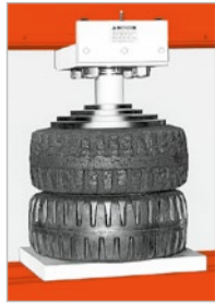
使用Power Team 壓機將輪圈壓入新輪胎中
