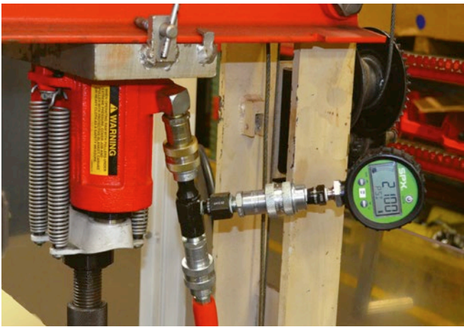
▶ Power Team 9042DG 在H型壓床應用中準確監測施加力量
