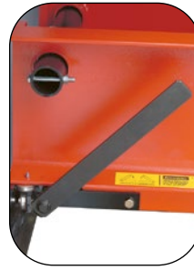
放下槓桿壓接, 提起槓桿滾動
