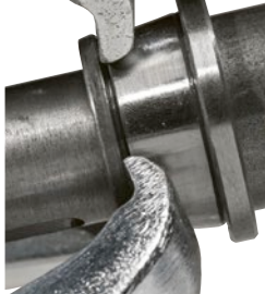
拉拔安裝於軸上的錐形滾子軸承
